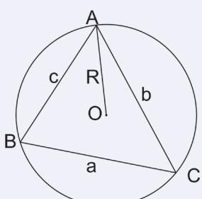
Şekildeki ABC üçgeninin O merkezli, R yarıçaplı çevrel çemberi verilmiştir. Üçgenin kenarları ve açıları arasında  $\frac{a}{\sin \widehat{A}} = \frac{b}{\sin \widehat{B}} = \frac{c}{\sin \widehat{C}} = 2R$  bağıntısı vardır.
