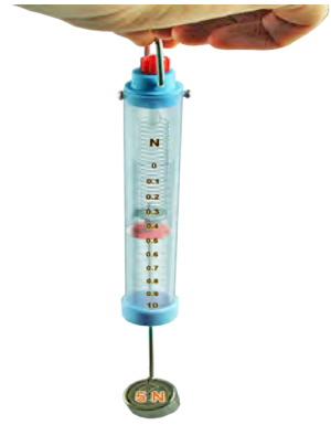
Görsel 3.8: Dinamometreye uygulanan kuvvet arttığında uzama miktarının artması
